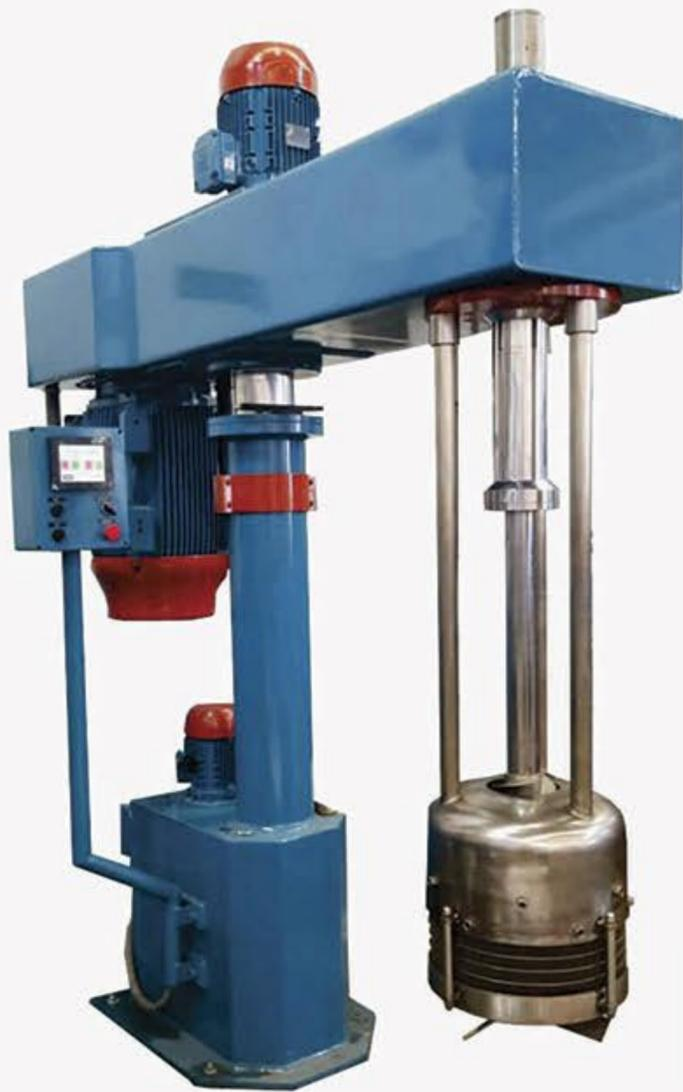
El molino de cesta procesa productos de baja, media y alta viscosidad a gran velocidad, permitiendo la distribución de partículas de manera uniforme llegando a partículas nanométricas.
